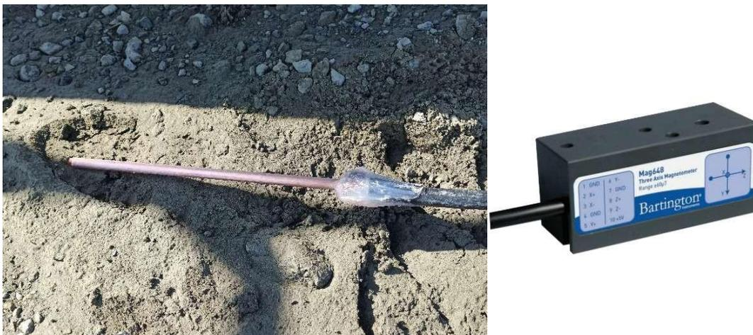
**Figura 3.** Sensores para campo electromagnético. A la izquierda electrodo polo a tierra de cobre, a la derecha magnetómetro Bartington Mag648L
