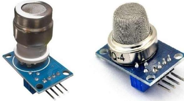
MG811 y a la izquierda el sensor de metano (CH<sub>4</sub>) MQ-4
