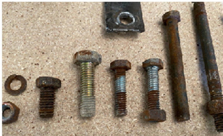
Fotografía 5. Inspección empleando la técnica de inspección visual detallada en los pernos de Turbina Eólica año 2020. Autor CT. JIMENEZ FAC.
